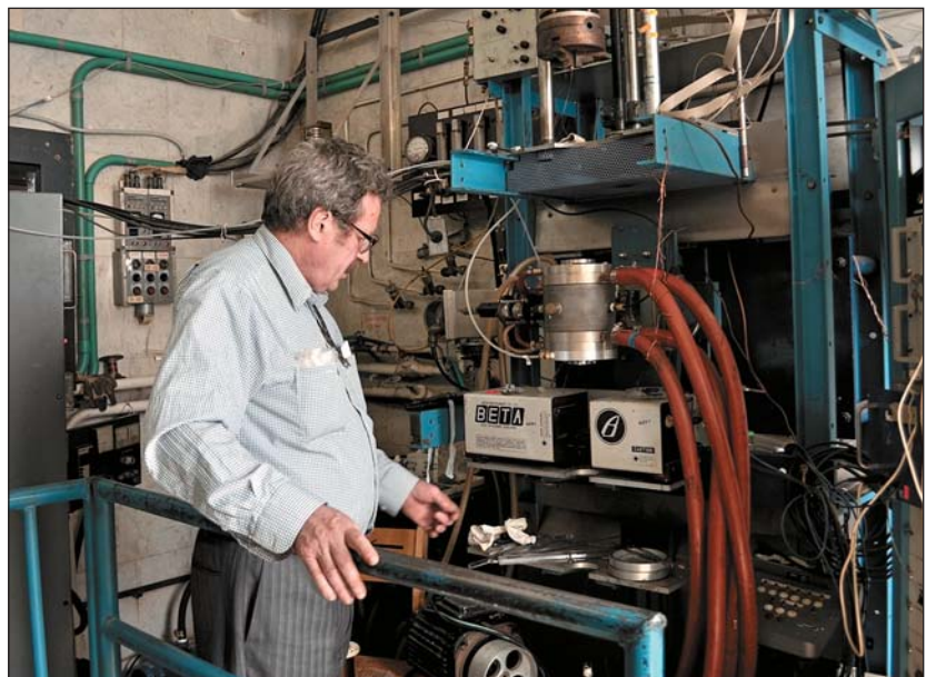
В.А.Богатырев налаживает установку для вытяжки волоконных световодов.
